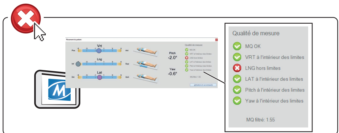
Figure 56 Exemple de message d'erreur lorsque l'indicateur de qualité de la mesure s'affiche en rouge
