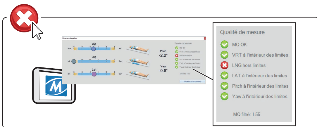
Figure 55 Exemple de message d'erreur lorsque l'indicateur de qualité de la mesure s'affiche en rouge
